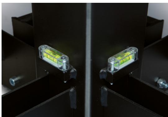
2 niveaux à bulle pour mise à l'aplomb
