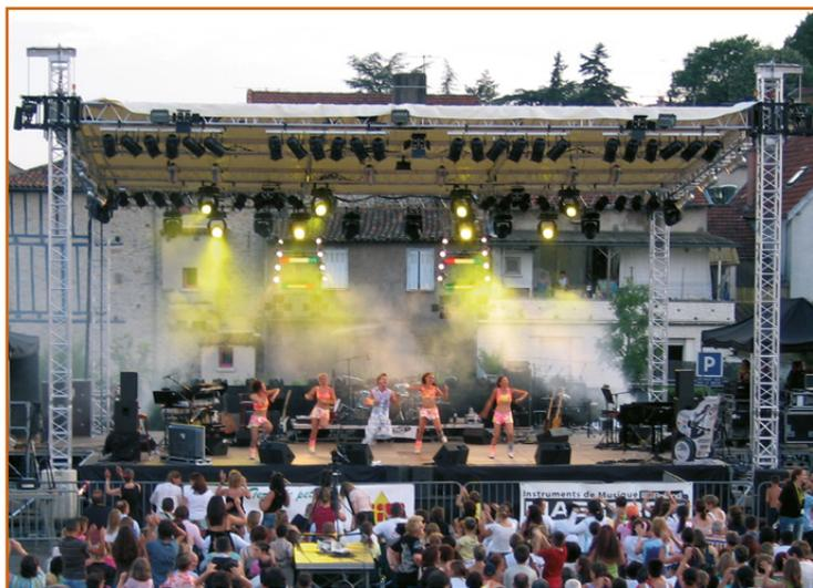
Réalisée sur la base de tours TL 400 et d'éléments standards SC 390 et SC 290 FC, la scène couverte à toit incliné (toit, côté et arrière) offre une surface utile de 12 x 10 m.
