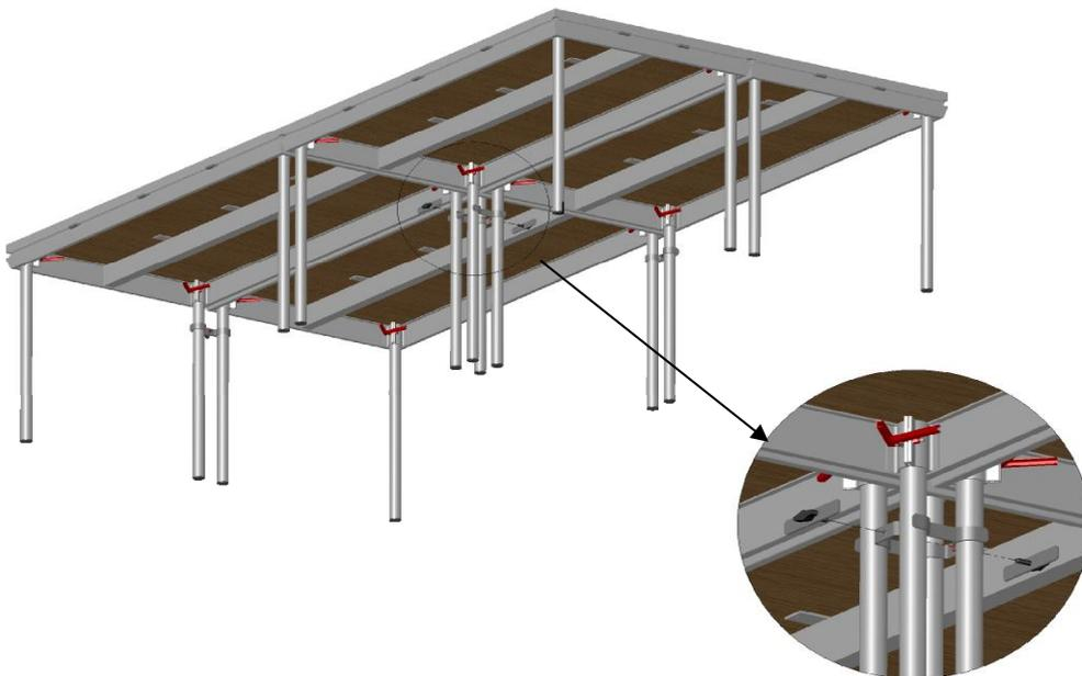
**A partir de pieds de hauteur de 1m,** il est vivement conseillé d'installer des systèmes de liaison de pieds (Réf. RAC4) sur les nœuds à 4 pieds et brider à l'aide des deux vis papillon.
