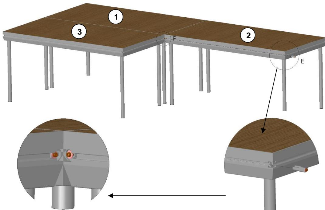
Insérer le système de plaquage horizontal (Réf. C0011) dans les rainures des deux praticables et brider en serrant la vis.
