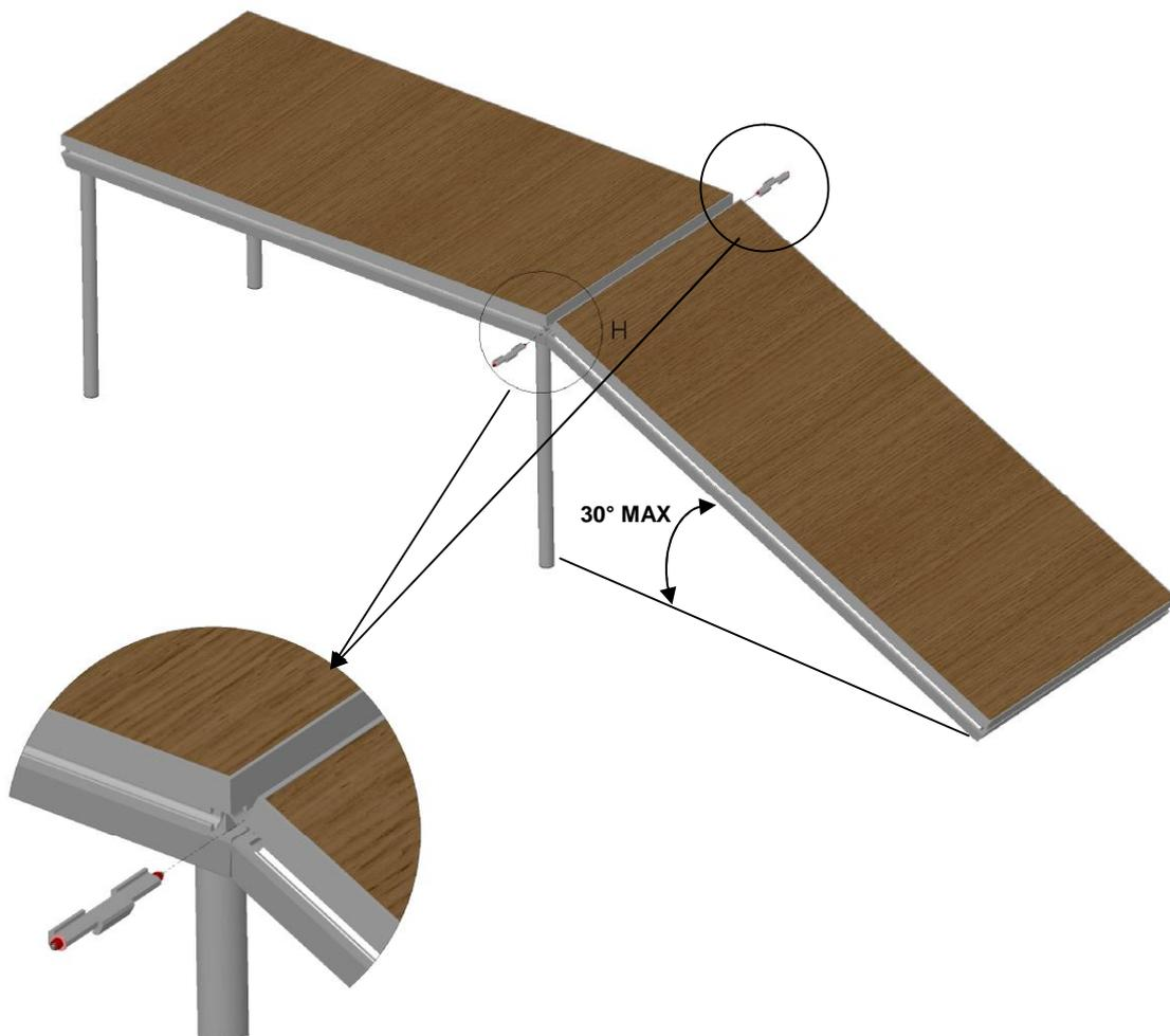
Insérer les systèmes de jonction inclinée (Réf. C0012) dans les rainures des deux praticables, de chaque côté du plan incliné.
