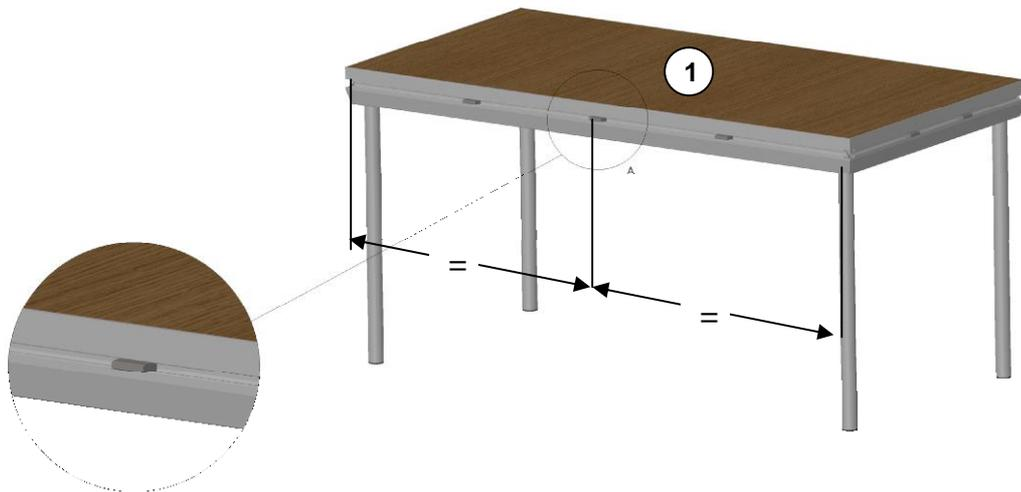
Insérer les pièces de mise à niveau (Réf. C0013) dans la rainure du praticable par son extrémité.
